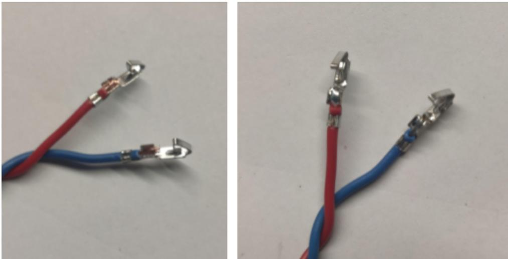
Les pins une fois étamés viennent s'enclencher dans la partie plastique. Attention aux polarités de certains câbles, suivre la notice pour le sens d'insertion des pins dans la partie plastique. Chaque pin doit entrer sans forcer jusqu'à entendre ou sentir un clic.
