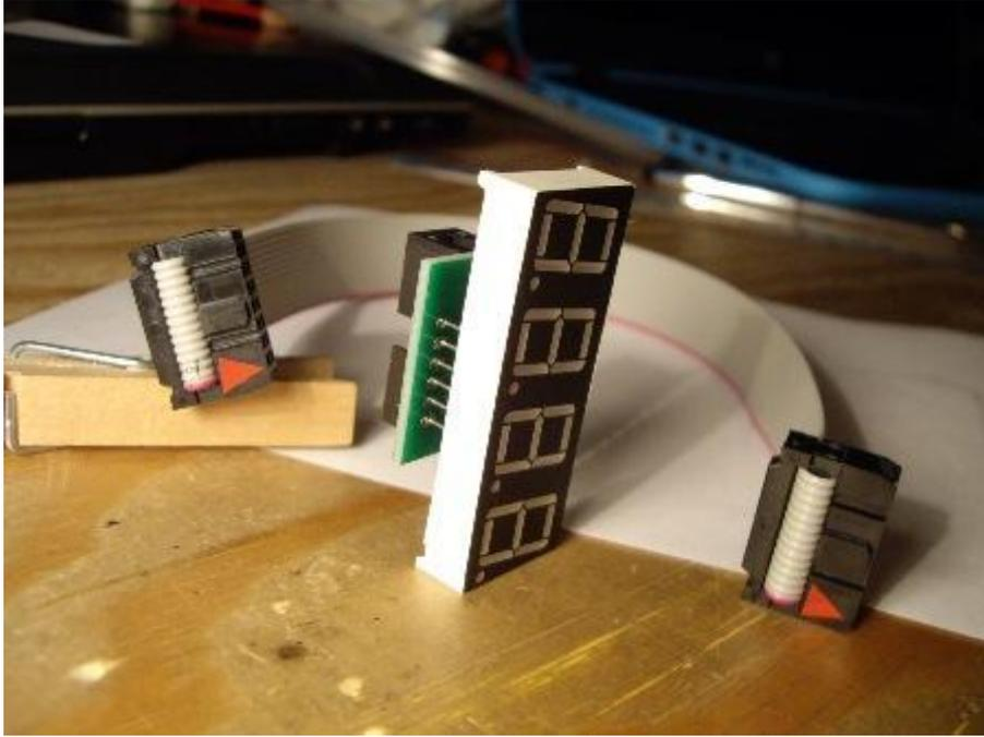
Ici, l'ensemble de câble ruban terminé est sur le point d'être inséré dans la prise d'en-tête sur la plaque d'adaptation.
