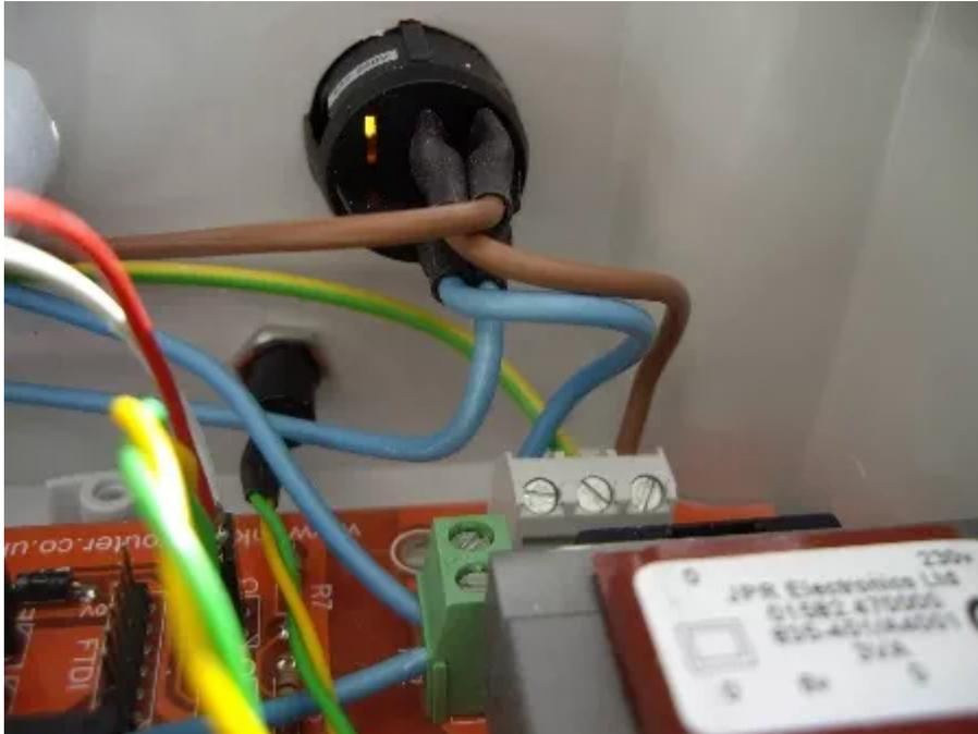
Le neutre pour les voyants des interrupteurs "marche" et "marche forcée" peut être raccordé sur TB2.
