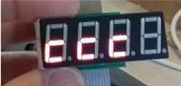
Si le module d'affichage est monté à l'envers, l'affichage ne fonctionnera pas correctement.
