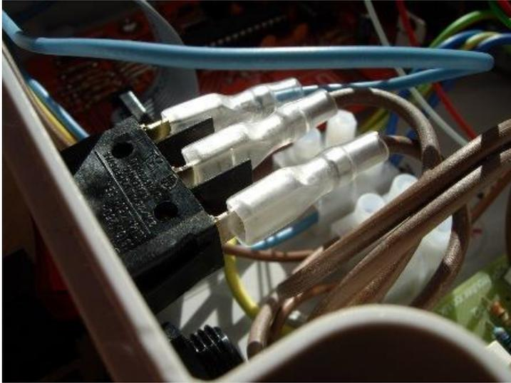
Voici l'interrupteur de forçage avec son ensemble complet de cosses. Le fil bleu (à faible courant) est un neutre commuté pour l'éclairage.
