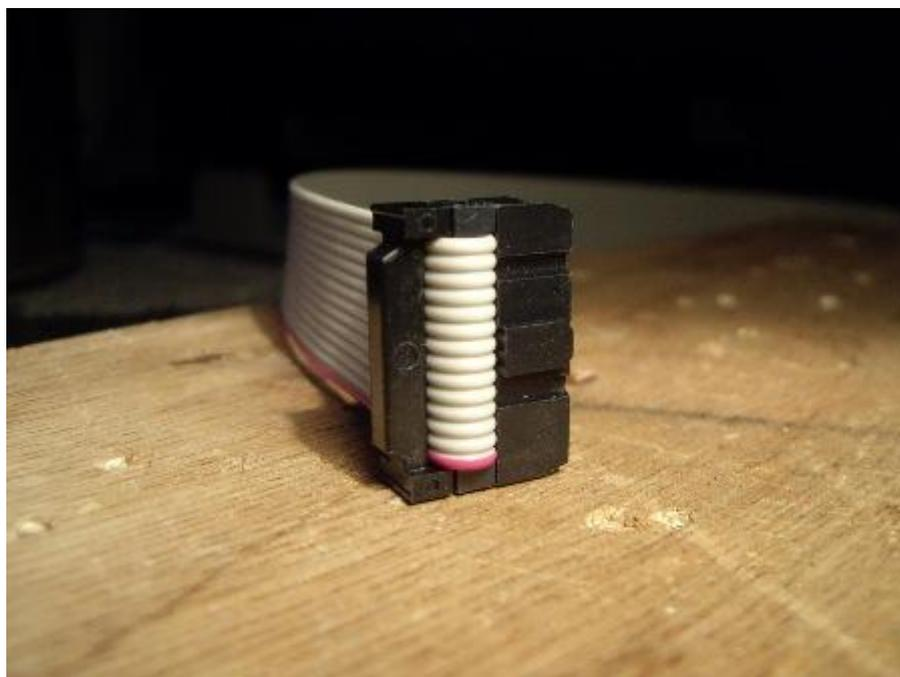
Bien qu'à peine visible sur ces photos, la marque triangulaire sur le corps du connecteur IDC est à côté de la ligne rouge du câble.
