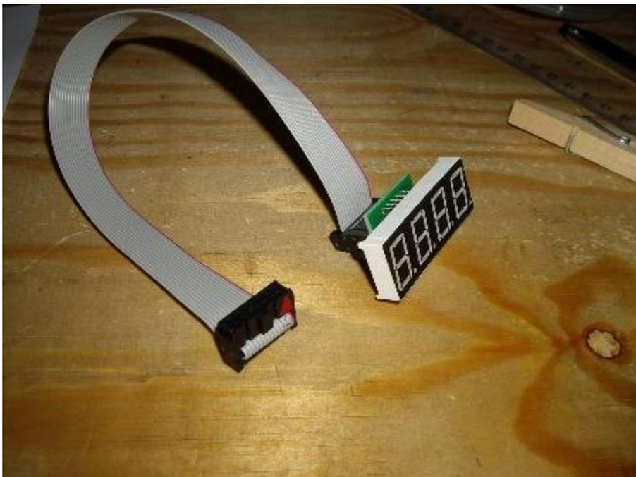
Voici l'assemblage terminé : module d'affichage, plaque d'adaptation et câble plat.
