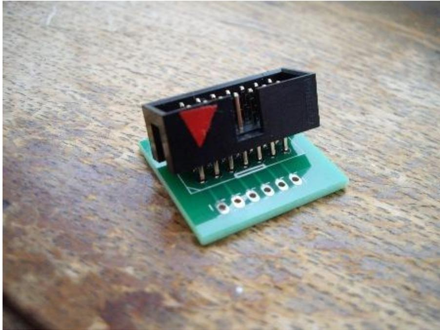
Lorsqu'il est correctement placé, ce composant peut être directement soudé. Seules 12 de ses 14 broches sont utilisées. Le sens d'implantation (entre prise et PCB) est indiqué sur la PCB par le petit rectangle blanc qui doit correspondre avec l'ouverture du clip sur la prise. Pour le sens entre cet ensemble et l'afficheur, il faut que les points décimaux de l'écran soient vers l'ouverture du clip de la prise. (voir photo suivante)
