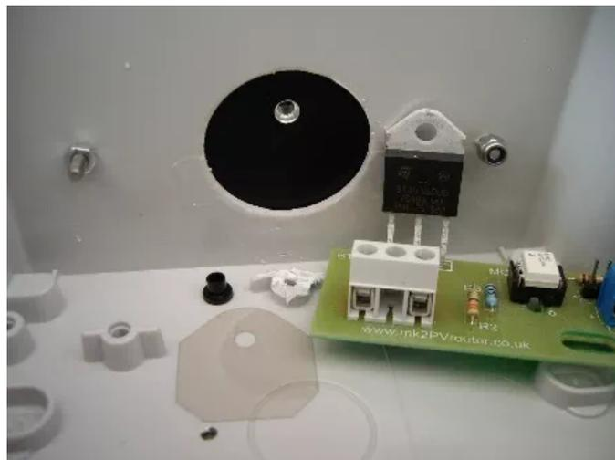
**L'emplacement du perçage doit être ajusté !** (voir : a- Ajuster la hauteur de perçage pour le triac)
